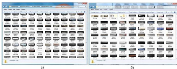
Рис. 2. Изображения из обучающей выборки: а) изображения сегментированных автомобильных номерных знаков; б) фоновые изображения
