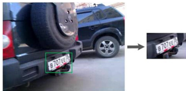
Рис. 3. Выделение автомобильного номерного знака
